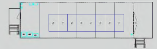
ЗРУ-35 с помещением ОПУ
