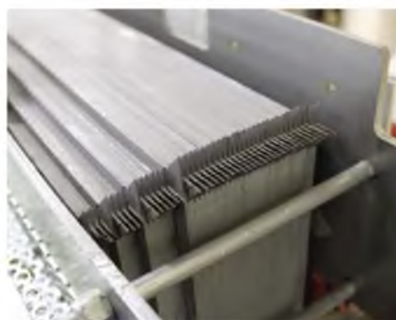
Рис.5. Стыковка стальных пластин под углом 45° и шихтовка по технологии Step-Lap
